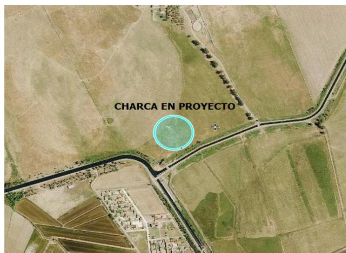
La balsa ocupará una superficie de 25.000 m<sup>2</sup> con una profundidad de 3,5 metros. El volumen de la balsa será de 81.000 m<sup>3</sup>.
